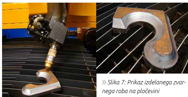
» Slika 6: Prikaz izdelave zvarnega roba s plazemskim rezanjem
