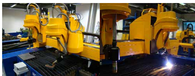
» Slika 6: Prikaz izdelave zvarnega roba s plazemskim rezanjem
