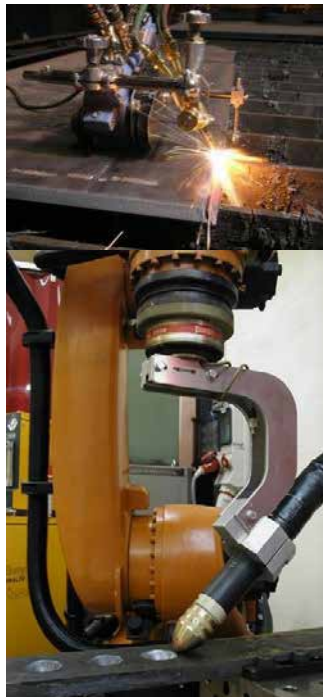
» Slika 1: a) Avtogeni postopek priprave zvarnih robov s samohodnim vozičkom in b) primer robotske priprave zvarnih robov
