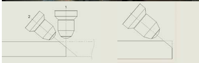
» Slika 4: a) Predhodno odrezani kos, ki mu želimo pripraviti zvarni rob, b) prikaz rezanja v dveh korakih in c) prikaz priprave roba
