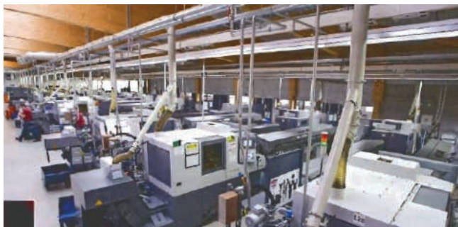
Impresivan pogled na proizvodnju tvrtke Loga Präzisionsteile oHG: točno 30 uzdužnih tokarskih automata Citizen Machinery Europe GmbH obrađuje visokozahtjevne komponente.
