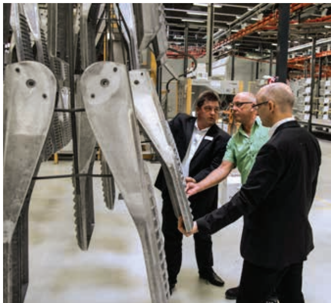
» Sitecova proizvodna linija za višefazni postupak bojanja različitih metala.
