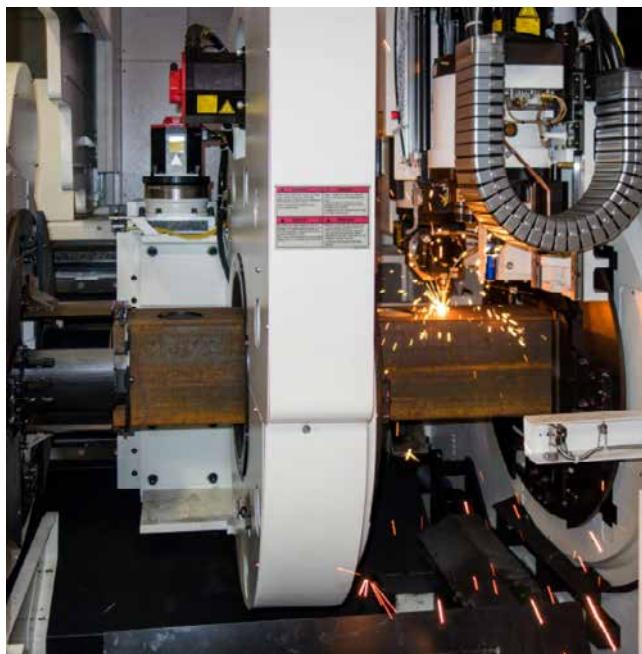
» 3D Fabri Gear 400 II s CO 2 laserjem moči 4 kW reže jeklene cevi s stenami debeline do 25 mm.
