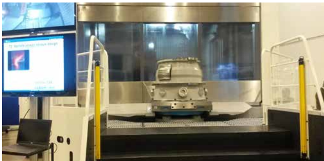
» Slika 2: Demonstracija obdelave litega ohišja iz inconela na stroju Makino T1
