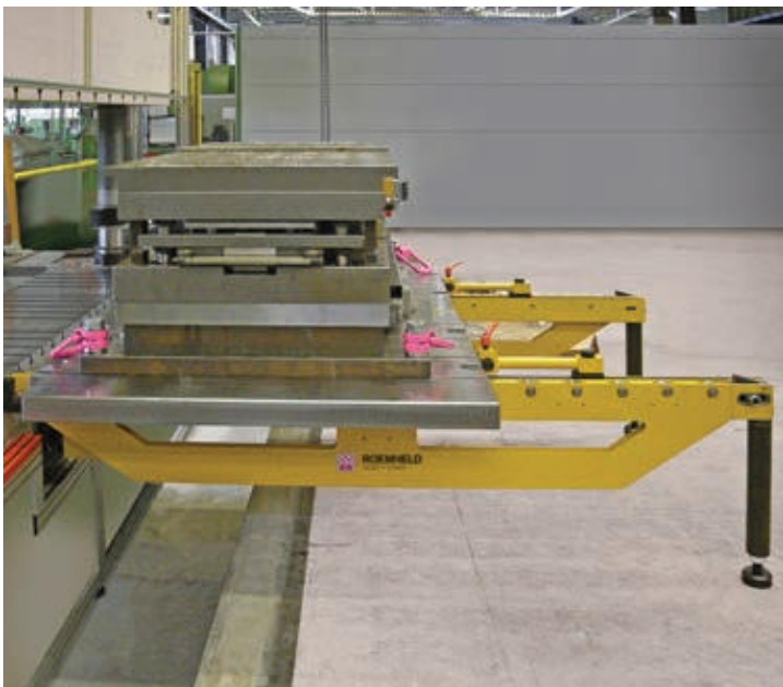
» Slika 2: Konzole za izmjenu alata s podupornim nogama i pogonom (Slika: ROEMHELD).
