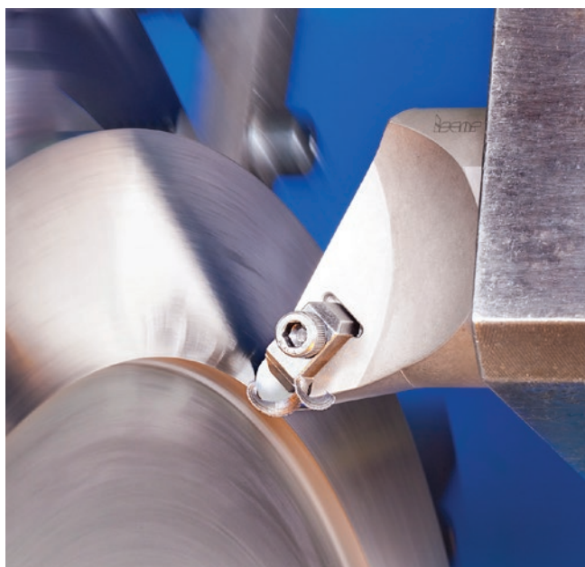
» Slika 1 – Super legure su ključni materijali za turbo mlazne i turbo propelerne motore suvremenih zrakoplova. Obrada diska mlaznog motora s pomoću ISCAR CUT-GRIP alata.
