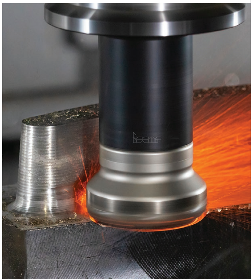
» Slika 3 – Glodala s izmjenjivim zaobljenim pločicama od keramike osiguravaju značajno povećanje brzina rezanja i višu produktivnost.
