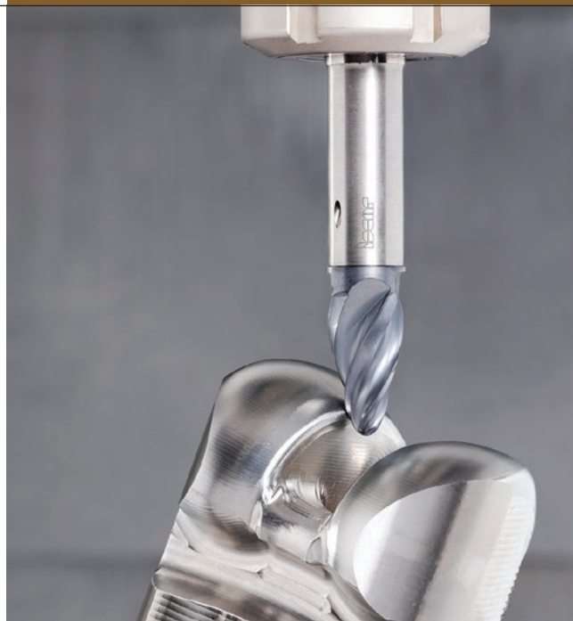
» Slika 2 – Obrada komponente implantata koljena s pomoću MULTI-MASTER vretenastog glodala s izmjenjivom konusnom glavicom.
