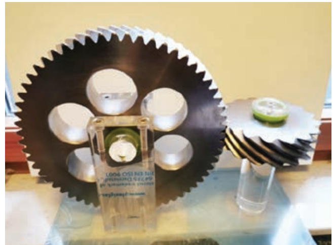
» Slika 10: Par S-zobnikov s pravokotno navzkrižnima osema, kot se uporabljajo v centrifugah
