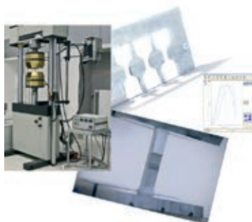
» Slika 6: Prikaz preizkušanja z natezno trgalno napravo za preverbo trdnosti spoja pri izbrani matriki parametrov (Avtor: Tadej Muhič)
