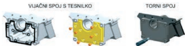
» Slika 3: Prikaz vijачnega spoja s tesnilko in izvedbe spoja z varjenjem z gnetenjem (Avtor: Dino Grbič)
