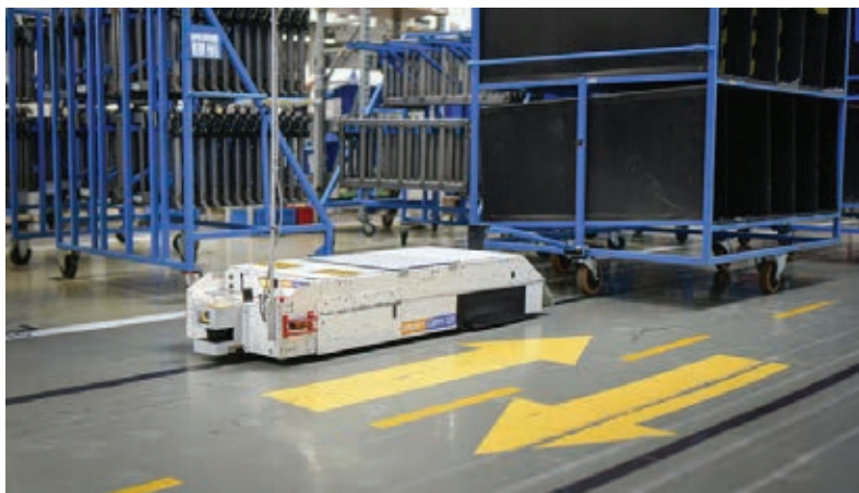
» V TPV so razvili lastno avtomatsko vodeno vozilo AGV za oskrbo delovnih mest, ki so ga poimenovali Optimatik 160. Foto: Jure Makovec
