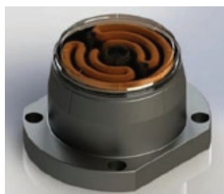
» Slika 5: Prikaz prereza (levo) in konstrukcije konformnega sistema v oblikovnem trnu (desno)
