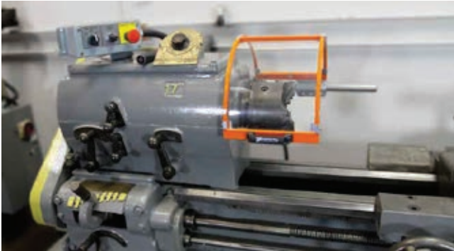
» Pri odmicanju električno povezane zaštite oslobađa se električni signal, koji pokreće signal za zaustavljanje stroja. | Izvor: MachineDesign
