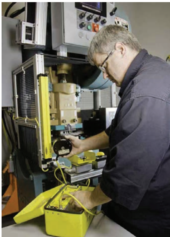
» Mjerenje vremena zaustavljanja stroja točno određuje, u koliko vremena od pritiska na tipku stop ili aktiviranja sigurnosnog prekidača dolazi do potpunog zaustavljanja opasnog djelovanja stroja. | Izvor: MachineDesign
