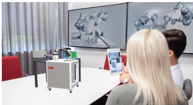
» Programska oprema RobotStudio tvrtke ABB se primjenjuje za simulaciju i programiranje izvan robota robota te služi za konfiguraciju opreme i virtualno postavljanje u fazi razvoja robotiziranih rješenja. | Izvor: ABB
