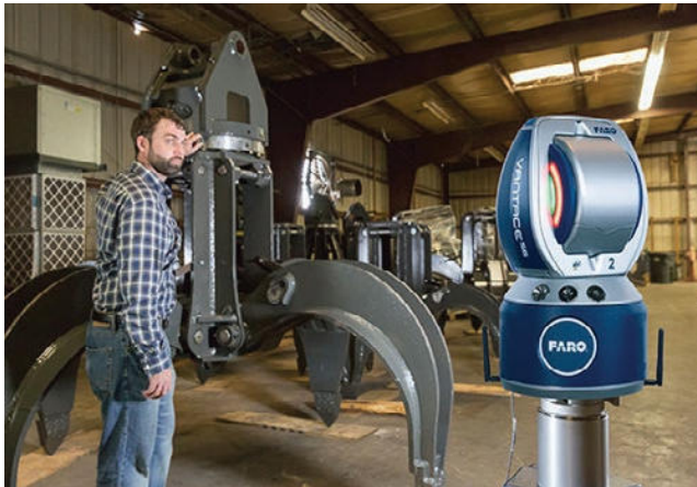
» Slika 3: Umerjanje sledilca FARO Tracker Vantage s tarčo
