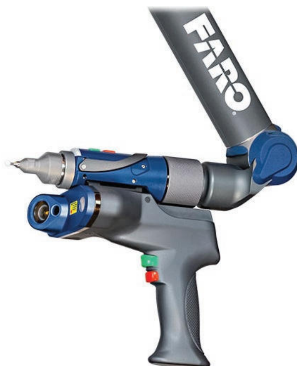
» Slika 2: FARO merilna roka s tipalom in laserjem
