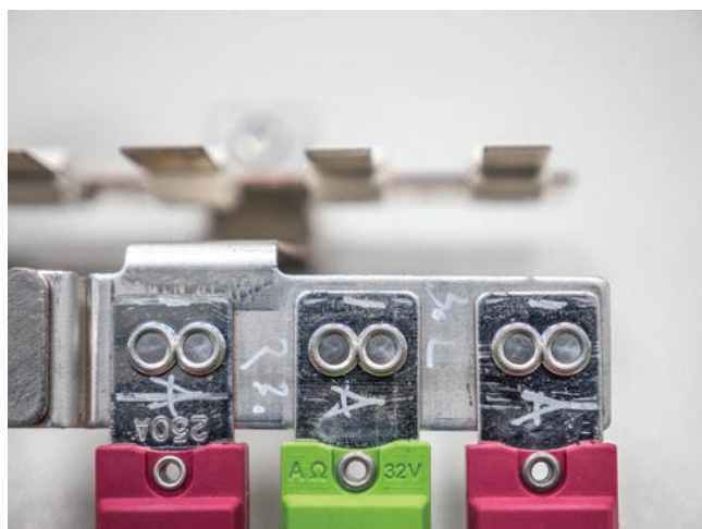
» Spoj TOX®-TWINpoint je varen pred torzijskimi obremenitvami.
