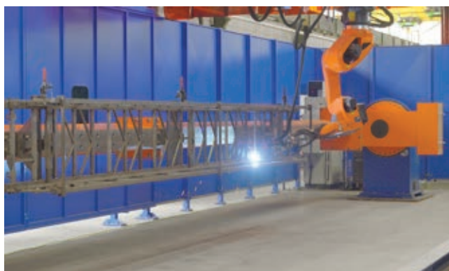
» Dva identična sistema za robotsko varjenje lestev na gasilskih vozilih. | Vir: Cloos
