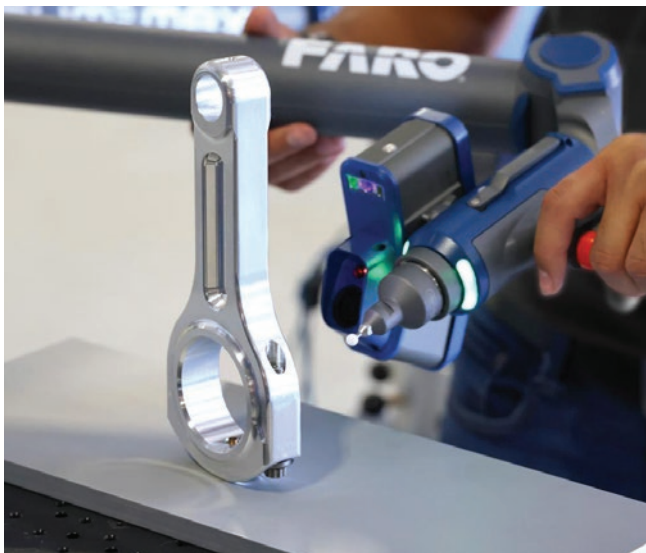
» Slika 5: Provjera točnosti izrađene klipnjače
