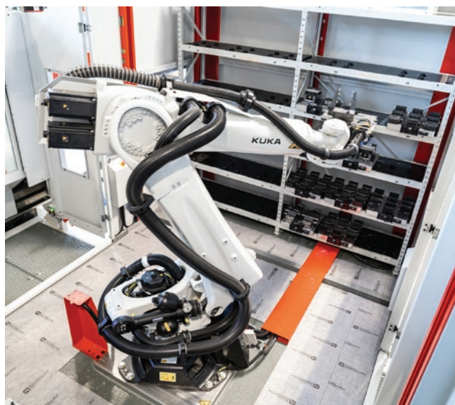
» Robotski sustav RS2 polaže sirovce u spremnik, prije nego li idu na obradu na obradni centar C 32 U. | Izvor: Hermle
