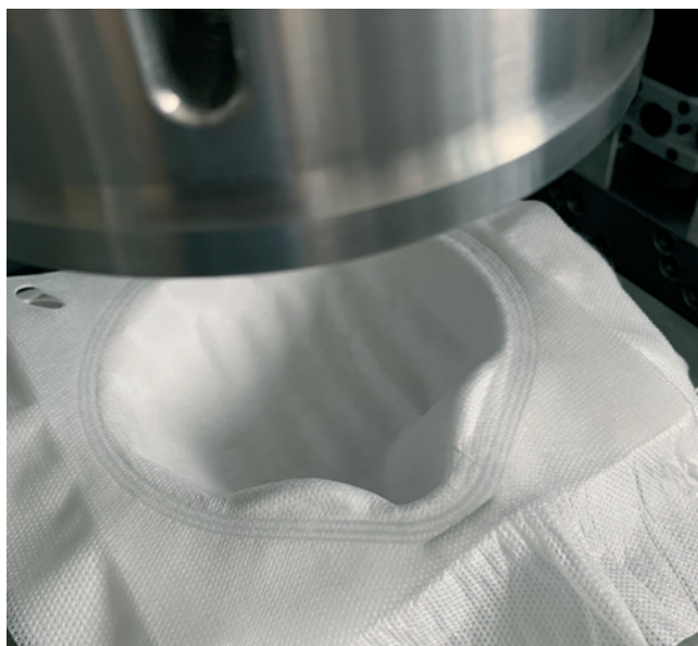
» Respirator po globokem vleku in varjenju robov z ultrazvokom Vir: Weber Ultrasonics
