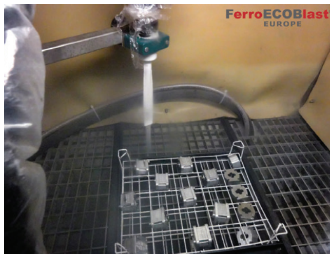
» Slika 3: Avtomatska rešitev podjetja FerroČrtalič za čiščenje s suhim ledom
