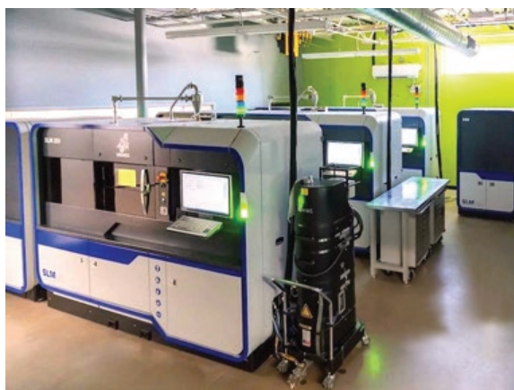
» Bertram Dental Lab uporablja pet strojev SLM280 PS za zagotavljanje storitev aditivne izdelave za delne proteze
