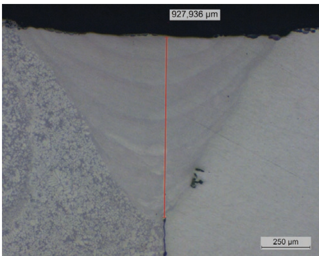
» Slika 5: Laserski zavar dvaju različitih materijala AISi10Mg(Fe) i AlMgSi 0,5 legure [Foto: TKC d.o.o.]
