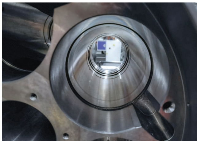
» Provrta s tri različita promjera, koji moraju biti obrađeni s visokom točnošću. | Izvor: Mapal
