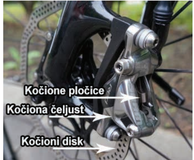
» Slika 2: Koćioni sustav kotača s diskom [1].
