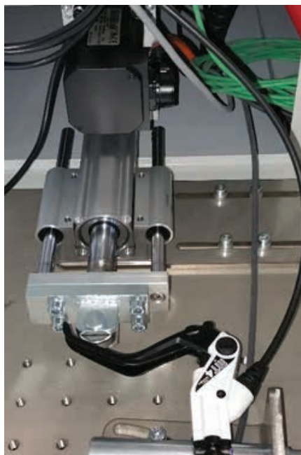
» Slika 4: Koćioni aktuator može pritiskati na pedalu za kočenje konstantnom ili promjenjivom silom.
