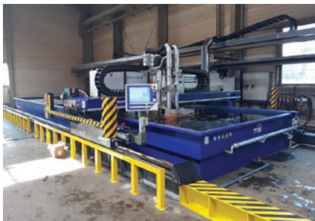
» Sistem za plazemsko rezanje MultiTherm proizvajalca Messer Cutting Systems v avstrijskem podjetju Jacquet Metallservice. | Vir: Messer Cutting Systems
