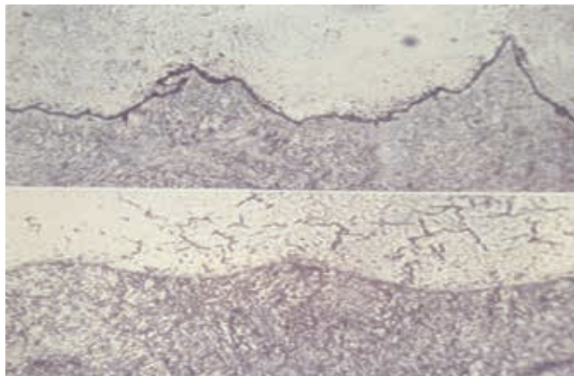
» Slika 3: Prikaz poboljšanja površine nehrđajućeg čelika prije elektropoliranja i nakon njega [1]
