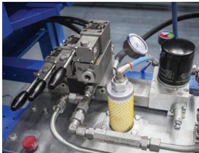
» Uređaj za rad nije potrebno priključiti na električni napon: jednostavno održavanje, hidraulički agregat pokreće stlačeni zrak.
