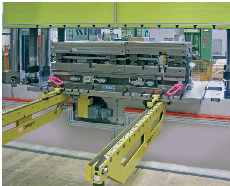
» Menjalna postaja ROEMHELD za orodja težka do 32 ton je zaradi elektromotornih nosilnih konzol varna rešitev za hitro menjavo orodja in se lahko uporablja na več stiskalnicah naenkrat (fotografija: ROEMHELD).
