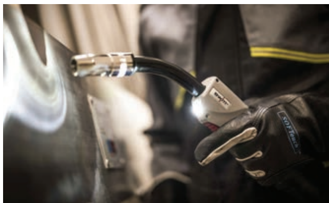
» Novi PM varilni gorilnik z vgrajeno LED-razsvetljavo omogoča delo na temnejših delih obdelovanca.
