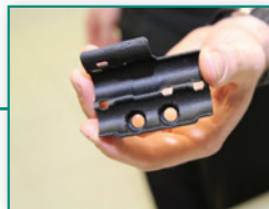
248 Dirkaška ekipa v formuli 1 McLaren uporablja 3D-natisnjene komponente za letošnji dirkalnik MCL32
