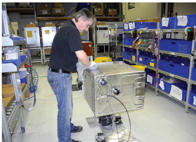
» V predmontaži oblepi sodelavec vseh pet strani z grelno folijo, pri tem mora vsebnik večkrat obračati (Slika: ROEMHELD)
