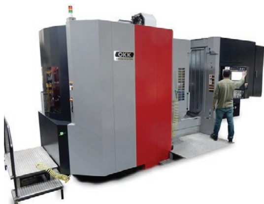
» Obdelovalni stroj HM1000s proizvajalca OKK zagotavlja hkratno štirirosno obdelavo, ima obsežno delovno območje ter vreteno z visokimi obrati in 60 konjskimi močmi. Vir: MoldMaking Technology
