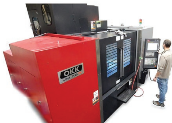
» Vertikalni obdelovalni stroj VM760R z dvostičnim vretenom CAT40 proizvajalca OKK zagotavlja boljšo kakovost končno obdelane površine ter visoko dimenzijsko natančnost obdelave. Vir: MoldMaking Technology
