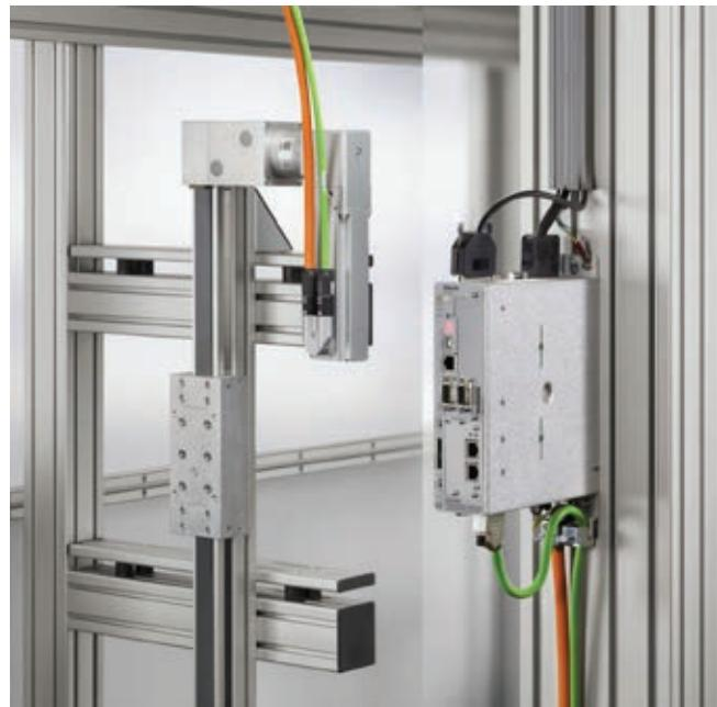
Za konstrukciju i montažu je važno, da sustav ima što manje veznih elemenata, najbolje samo jedan glavni i nekoliko pomoćnih, koje primjenjujemo samo u iznimnim slučajevima, kao što je naknadno ugradivanje elemenata bez mehaničke obrade (bušenja) ili posebni načini pričvršćivanja određenih elemenata. Spojni elementi trebaju biti oblikovani tako, da su vijci opterećeni samo na rastezanje.
