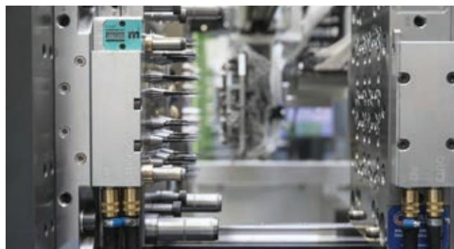
otpresci dovoljno ohlade, robot ih prenese u kalup sa 4+4 kalupne šupljine na kombiniranoj višekomponentnoj ubrizgavalici duo 600H/600H/500 s okretnim stolom, u kojoj se nanose još dva sloja PMMA, nakon čega robot easix uklanja gotove leće iz kalupa. Trajanje ciklusa je prilično manje od 3 minute, iako se predoblici hlađe oko 30 minuta.
