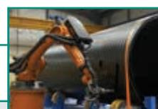
Proizvodnja plastičnih komponenta, primjerice za podzemnih cijevi, specijalnost su finske tvrtke Uponor Infra. Sa svojim proizvodom Weholite, tvrtka je razvila i patentirala rješenje za proizvodnju plastičnih cijevi duljine nekoliko metara i promjera do 3,5 metara. Te velike cijevi se primjenjuju primjerice za sustave gravitacijske drenaže, odvodnje, sub-terenskih kanala, sustava odvodnih kanala i u niskotlačnim aplikacijama.
